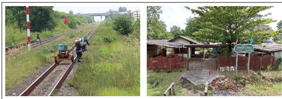
รูปที่ 2.2-13 รถยนต์ราง (รถตีก) ซึ่งมีไว้สำหรับตรวจสอบทางรถไฟและที่ทำกรนายตรวจทาง
